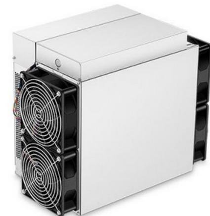
*Machine couramment utilisée pour le minage: Antminer S19 Pro*
